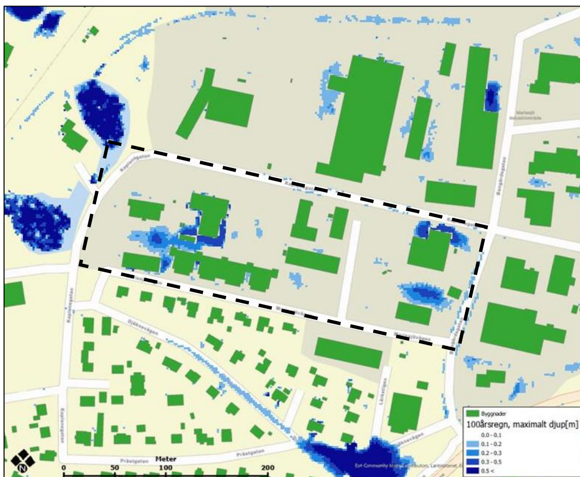
Figur 9. Skyfallskartering över Tegelbruket med omnejd och maximalt vattendjup vid ett 100-årsregn med 6 h varaktighet.
