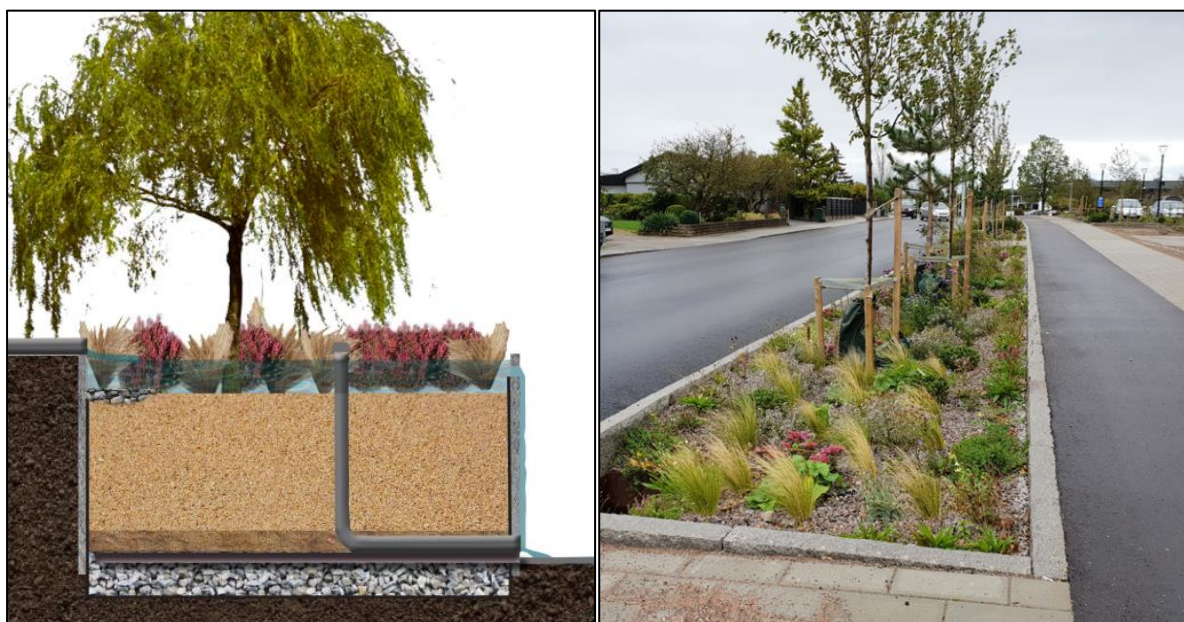
Figur 11. Exempel på trädgrop/regnrabatt. Illustration: (vänster) Åsa Wellander (Wellander, 2015), Foto: (höger) Edge (Thynell, et al., 2019)
